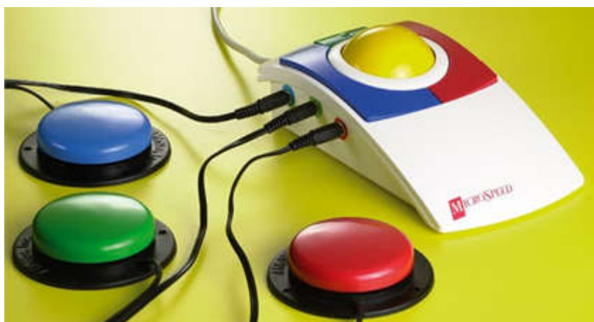
Рис. 6 Специальная мышь-роллер с подключенными с выносными кнопками
